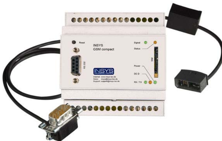
Bild Datenkabel verbindet Logo mit Insys GSM compact
