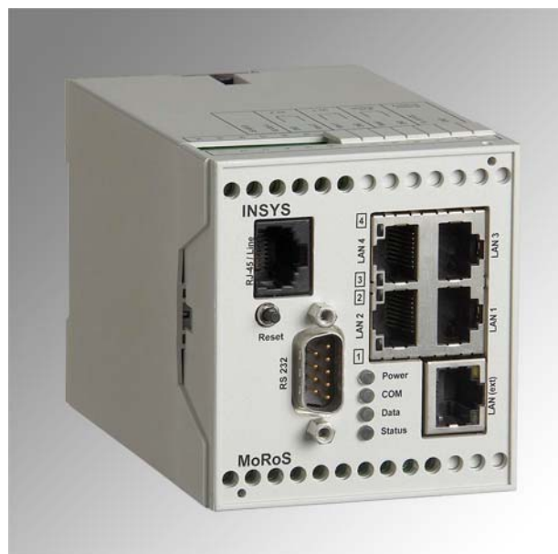
Bild 1: MoRoS LAN PRO verbindet lokale Netzwerke direkt oder über das Internet mit dem Leitstand
